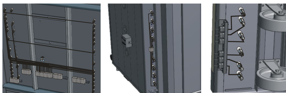
Fig. 96: Eksempel: Varmeelementer i en vognsovn (avhengig av modell) (illustrasjonen kan avvike)
